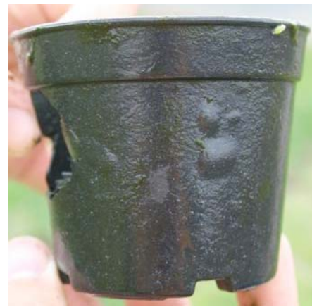
Abbildung 1: Nach 7 Monaten im Wasser zeigten die Töpfe Blasen und eine verringerte Stabilität, waren aber unverformt und unbeschädigt (die Beschädigung des abgebildeten Topfes ist erst durch mechanische Einwirkung nach Versuchsende entstanden)
