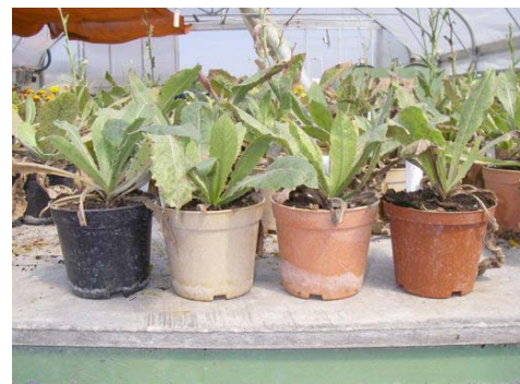
Abbildung 2: Verfärbungen an den NAWARO-Töpfen, beim rechten Topf handelt es sich um den Vergleichstopf aus Kunststoff
